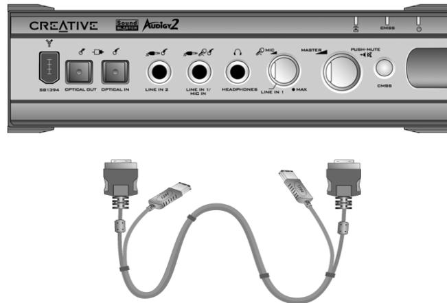
Рис. 2-1: Модуль External I/O Module и кабель AD\_LINK
