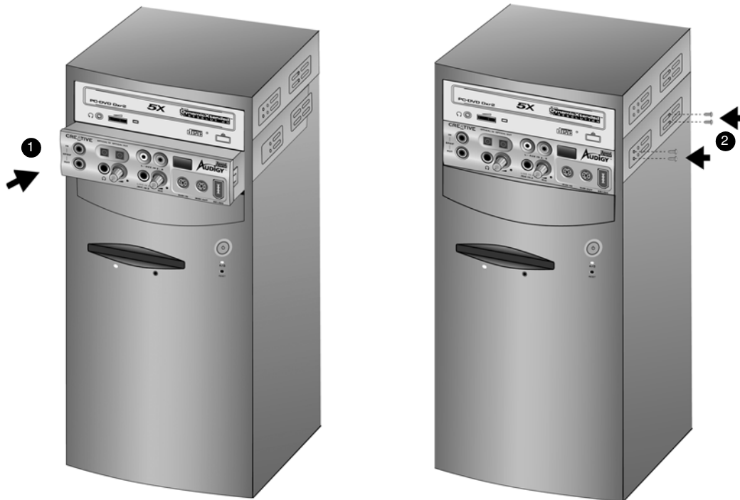
Rysunek 1-10: Instalowanie urządzenia Audigy 2 Drive
