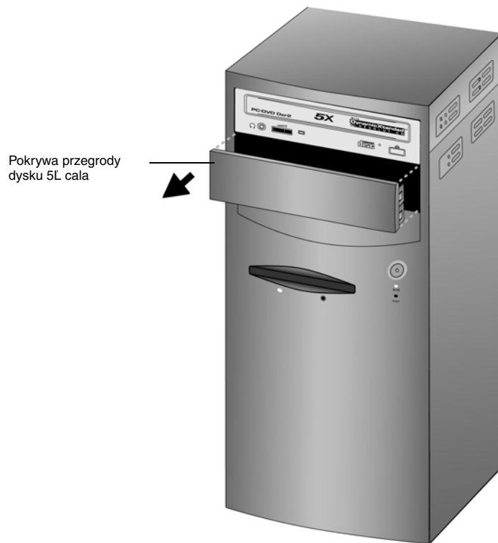
Rysunek 1-8: Usuwanie pokrywy przegrody dysku 5L cala.
