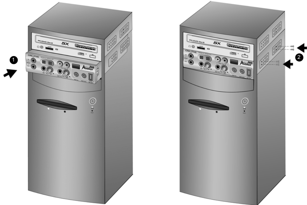
Afbeelding 1-10: De Audigy 2-drive installeren.
