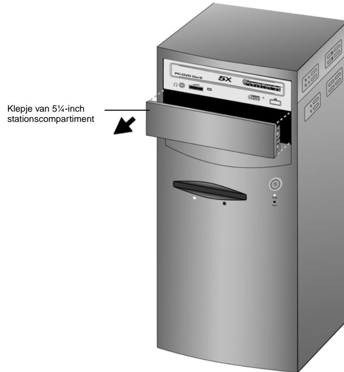
Afbeelding 1-8: Het klepje van een 5¼-inch stationscompartiment verwijderen.
