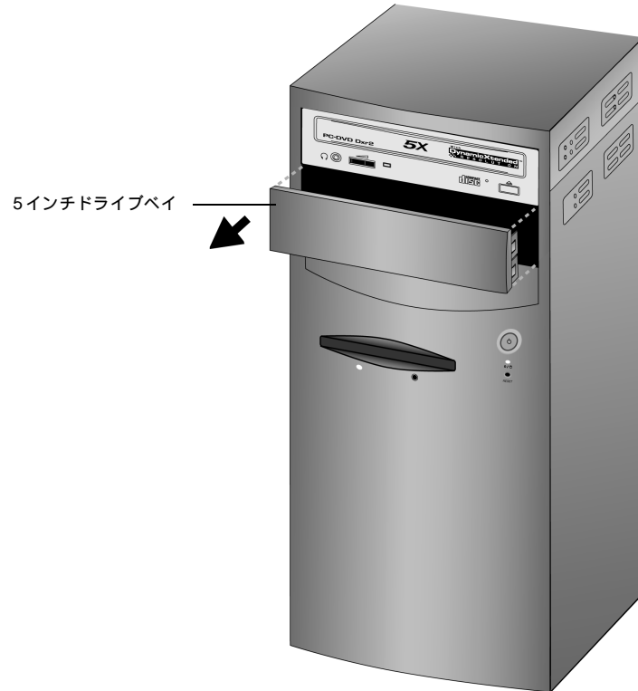
図1-8 5インチドライブベイカバーの取り外し
