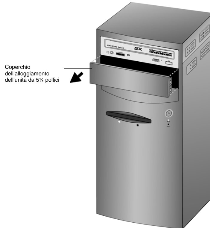
Figura 1-8: Rimozione del coperchio dell'alloggiamento dell'unità da 5¼ pollici
