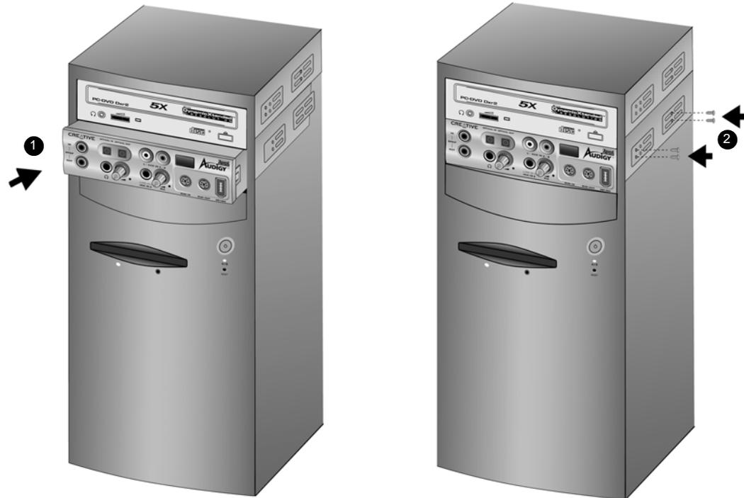
Abbildung 1-10: Installieren des Audigy 2-Laufwerks
