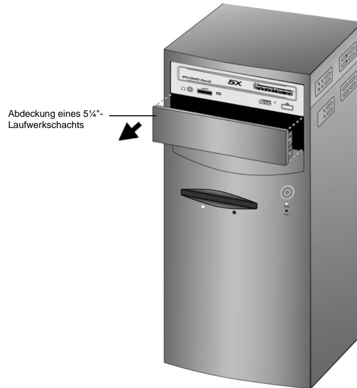
Abbildung 1-8: Entfernen der Abdeckung eines 5¼"-Laufwerkschachts
