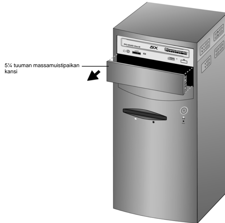
Kuva 1-8: 5¼ tuuman massamuistipaikan kannen irrottaminen.
