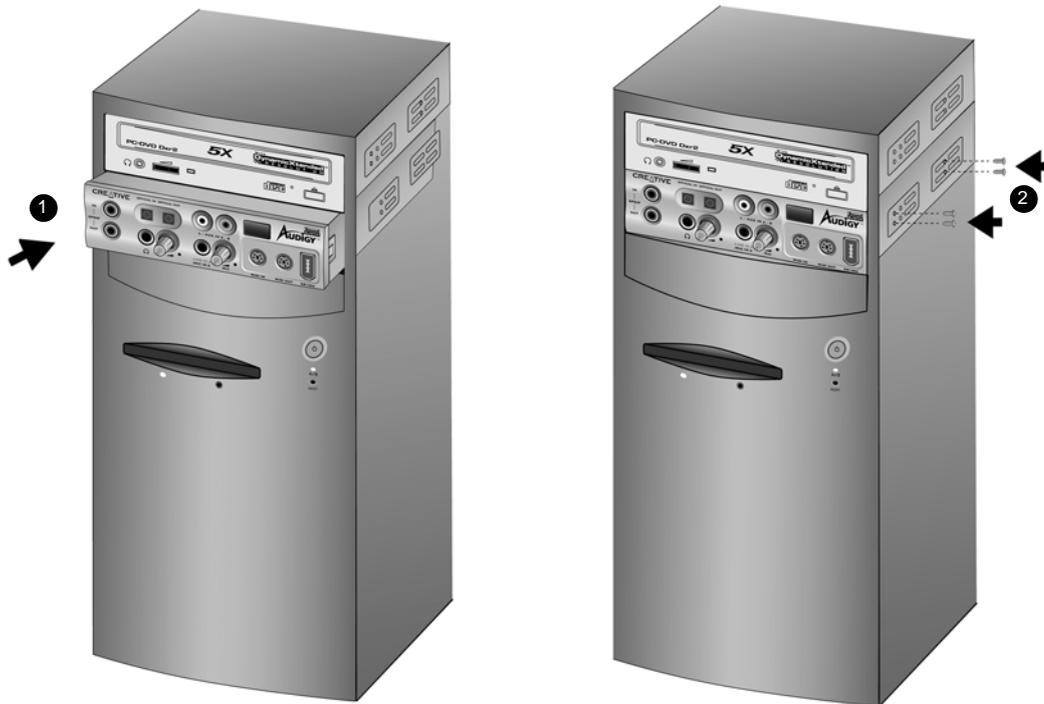
Figura 1-10: Instalação da unidade Audigy 2.
