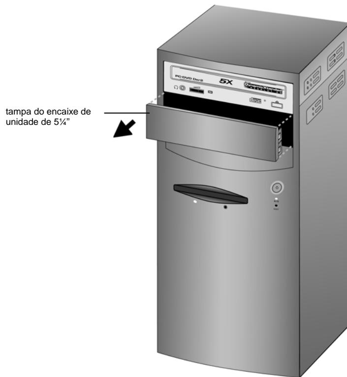
Figura 1-8: Remoção da tampa do encaixe de unidade de 5¼".
