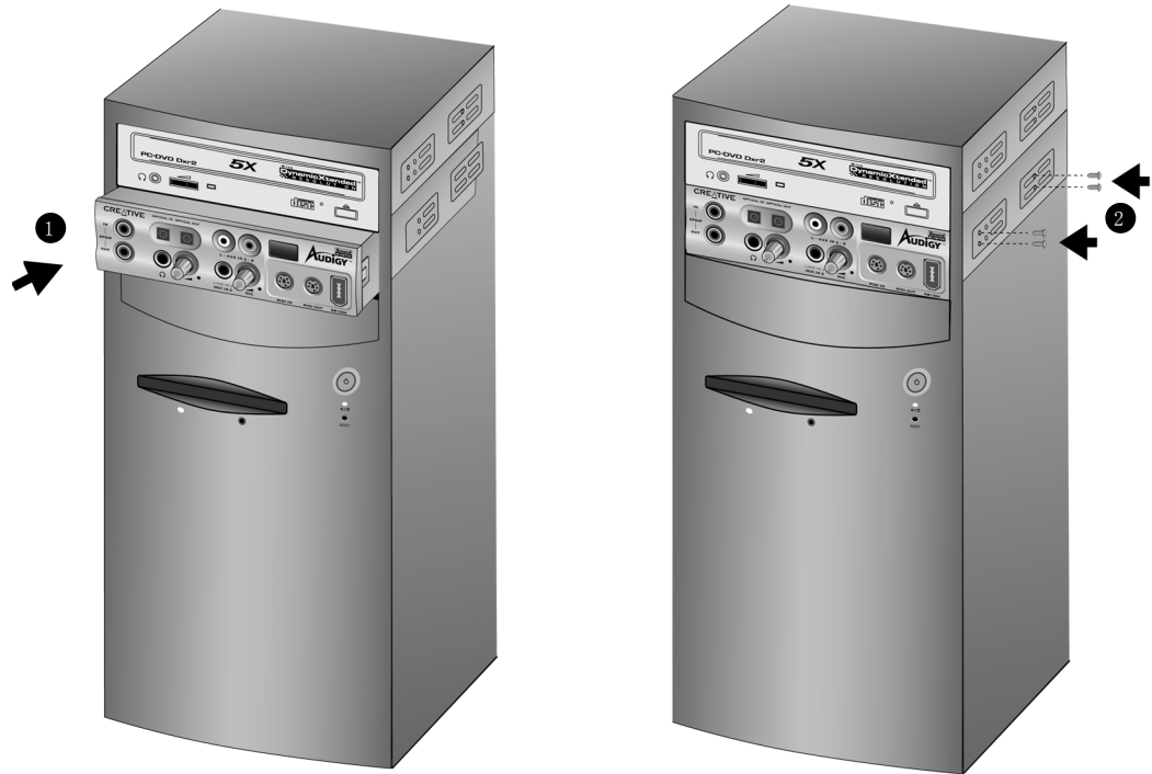
图 1-10: 安装 Audigy 2 Drive。
