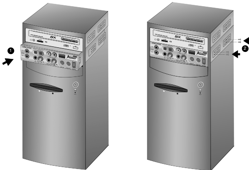
Figura 1-10: Instalación de la unidad Audigy 2.
