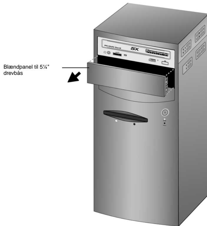
figur 1-8: Afmontering af blændpanel til 5¼" drevbås.
