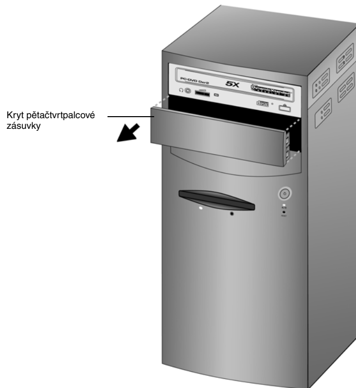
Obr. 1-8: Odstranění krytu pětáctvrtpalcové zásuvky
